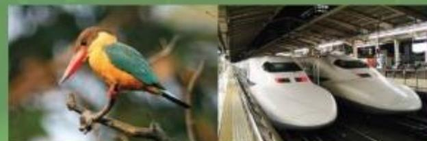
A resolução dos problemas de poluição sonora causados pelo comboio **Bullet Train** na saída dos túneis, quando viaja a mais de 300 Km/h, consistiu numa remodelação da fuselagem do comboio, mimetizando a forma do bico do guardanivós que, ao mergulhar a alta velocidade, faz um mínimo de ruído. O resultado é um comboio silencioso, uma redução de consumo de 15% e um aumento de velocidade de 10%.
