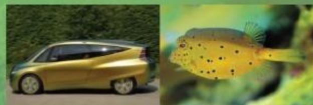
O **carro biónico** desenvolvido pela Mercedes-Benz a partir da forma do peixe cofre, atinge um coeficiente de aerodinâmica de 0,19 e consome 20% menos combustível que um veículo convencional de potência equivalente.
